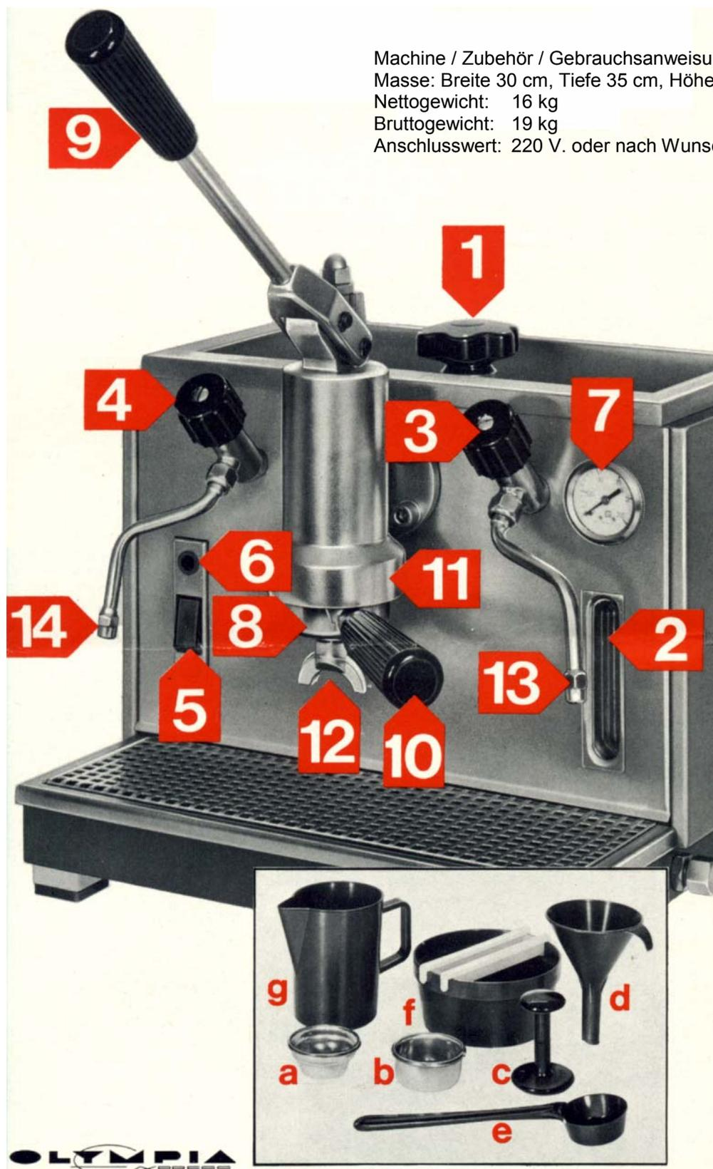
**A** Schraubverschluss (1) des Boilers öffnen und frisches Wasser einfüllen bis zum oberen Ende des Wasserstandsglases (2). Boiler wieder gut verschliessen. Dampfhaahn (3) und Heisswasserhahn (4) ebenfalls schliessen. Drehung nach rechts. Maschine an Strom anschliessen. Drucktaste (5) betätigen, diese und das Kontrollämpchen (6) für die Heizung leuchten auf.
